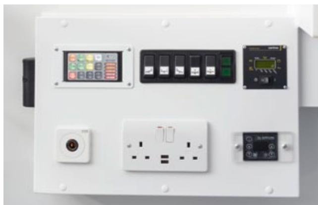
Zentrales Touchpanel zur Steuerung des elektrohydraulischen Tisches, der Klimaanlage und Beleuchtung.
