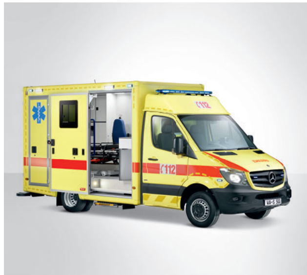
Die großzügig bemessene Schiebetür ermöglicht den störungsfreien Zugang zum Patientenraum auch bei beengten Platzverhältnissen im Parkbereich.
