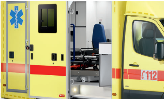
LED-Beleuchtung an allen wichtigen Punkten erhöht die Sicherheit und ist besonders energieeffizient.
