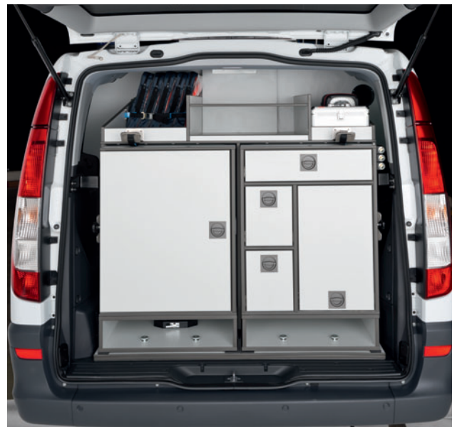
Die Schränke im Heck bieten viel Stauraum für Arbeitsmaterialien und Ausrüstung.
