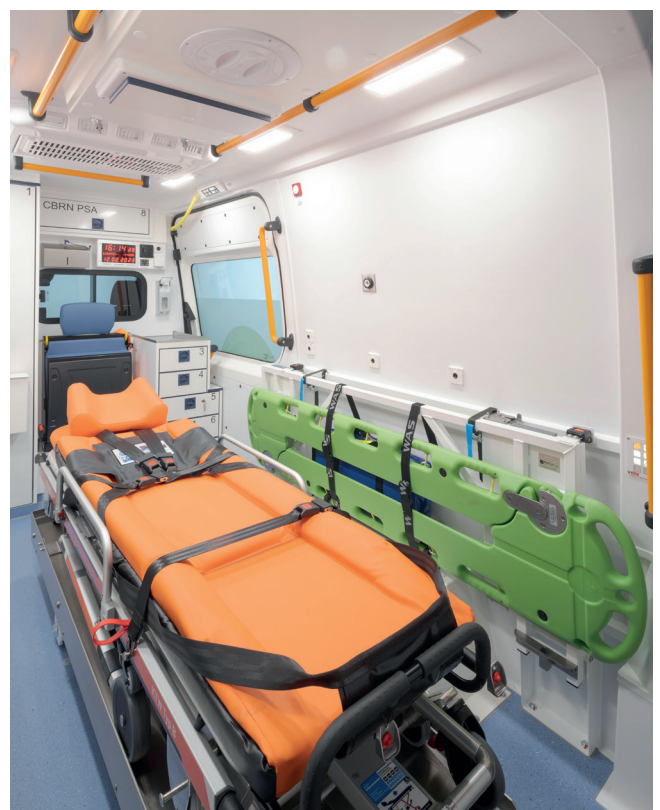
Die zweite Tragenlagerung mit einer Aufnahme für Schaufeltrage und Zubehör ist an der Seitenwand befestigt.
