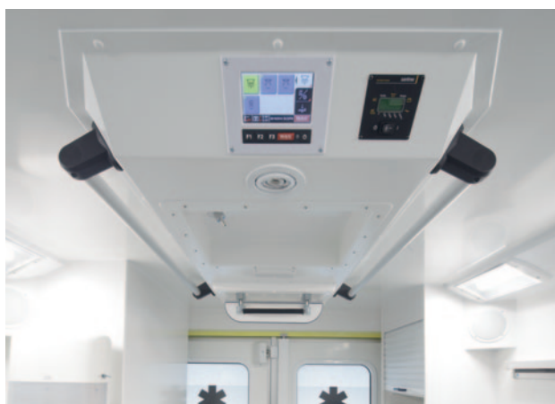
Übersichtlich: Zentrale Bedienung über das Touch Panel von Beleuchtung, Ambulanztisch und der Klimatisierung ergonomisch im Deckencenter integriert.
