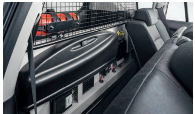
Die Funkgerätekomponenten, Sicherungen und ein Waffenkasten befinden sich vor Fremdzugriffen gesichert hinter der Rücksitzbank.
