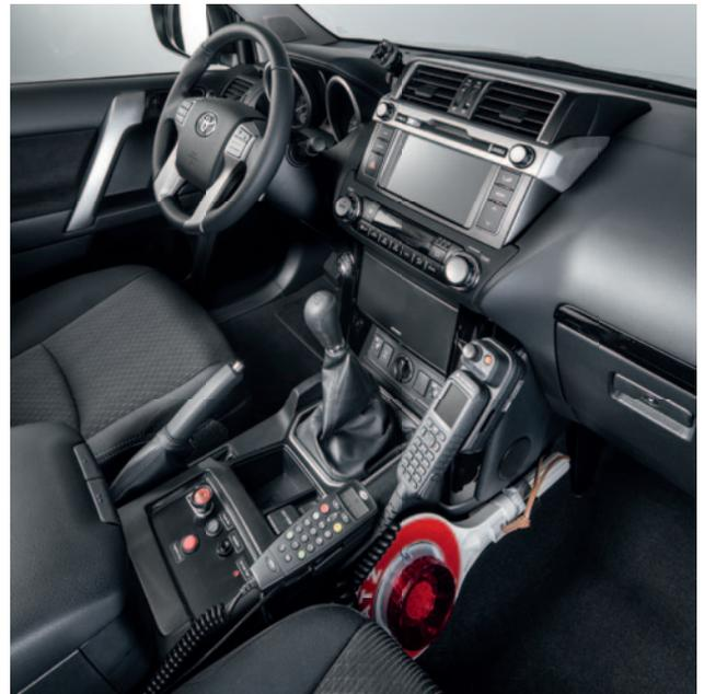
Armaturenbrett mit Digitalfunkgerät, Bedienteilen für die Sondersignalanlagen und eine zugriffsoptimierte Halterung für den Anhaltstab.
