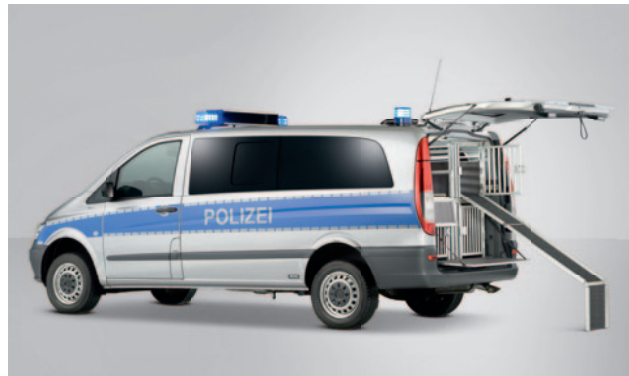
Die oberen Transportboxen können von den Hunden über eine Lauframpe erreicht werden.
