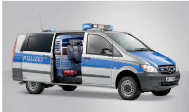
Der Wasserbehälter für die Versorgung der Hunde ist gut zugänglich im Zugriffsbereich der Schiebetür untergebracht.
