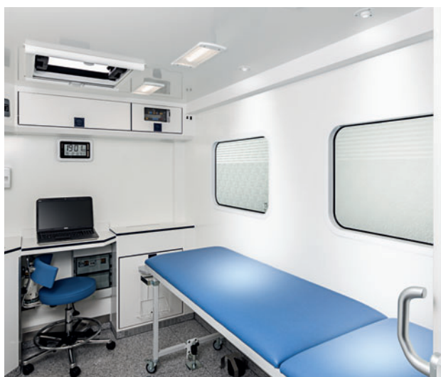
Die verschiebbare Patientenliege ermöglicht dem Behandelnden unversperrten Zugang zum Patienten. Energiesparende LED-Lampen und Arztspots sorgen für perfekte Ausleuchtung und optimale Behandlungsbedingungen.
