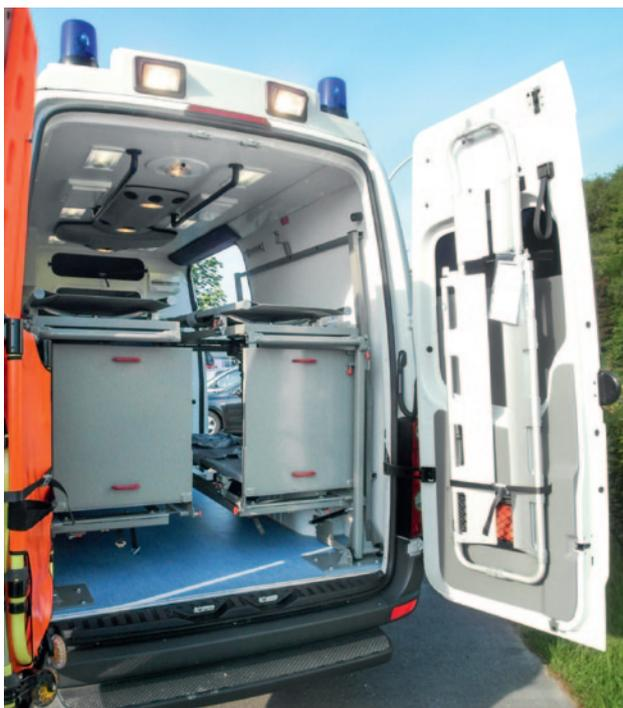
Wirbelbrett, Schaufeltrage oder Tragestuhl werden an den Hecktüren verlastet.
