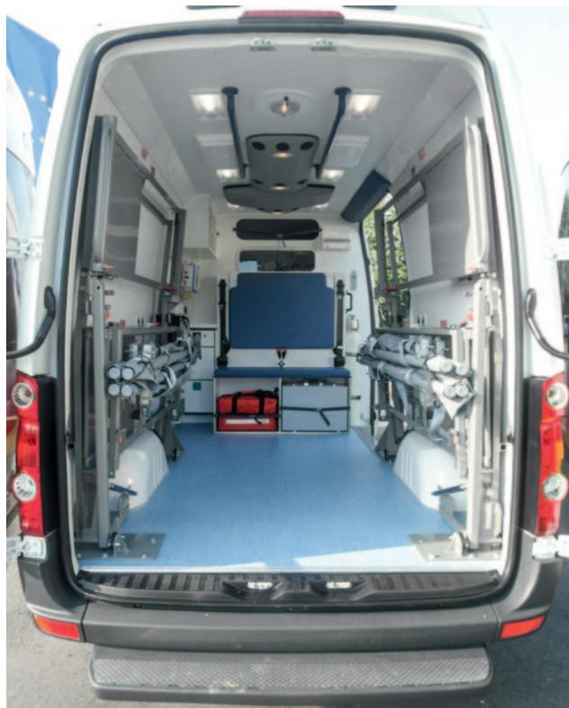
Die Tragenaufnahmen links und rechts können platzsparend an die Seitenwand geklappt werden.
