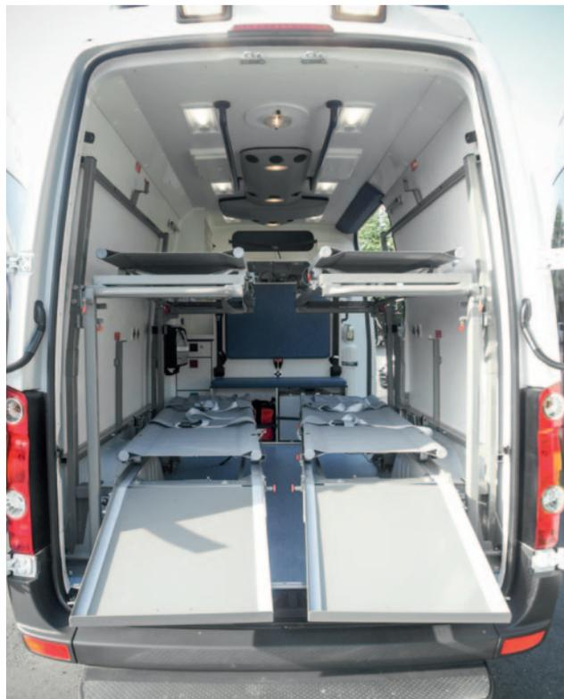
Die Tragenaufnahmen können abgesenkt werden, um eine ergonomische Beladung zu ermöglichen.
