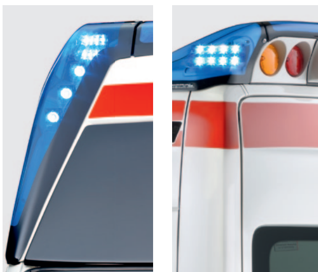
Die integrierte WAS 300 LED-Warnanlage übertrifft die neuesten technischen Standards.
