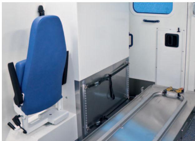
Praktisch: Die Halterung für einen ungenutzten Rollstuhl oder Gepäck ist einfach zu bedienen, sehr flexibel und hält sicher.
