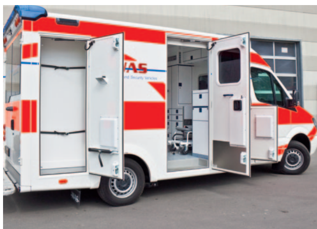
Die Außenklappen erweitern den Stauraum und sind leicht zugänglich.
