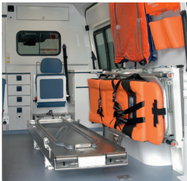
Hohe Flexibilität des Katastrophenschutz-KTW: Für den Standard-Einsatz mit einem liegenden Patienten wird die zweite Trage einfach seitlich hochgeklappt.
