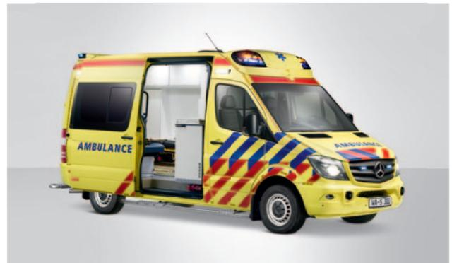
Die Seitentür verfügt über Schiebefenster und Schließhilfe. Die Sidebars mit RVS Auftritt erleichtern Ein- und Ausstieg.
