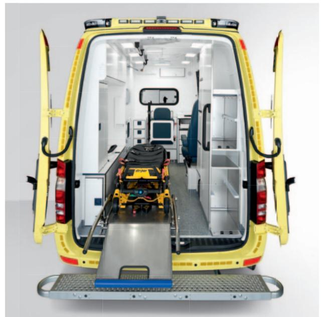
Das Move-In-Beladehilfssystem für die Fahrtrage ermöglicht ein besonders sicheres und ergonomisches Beladen des Rettungswagens.
