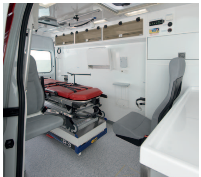
Bestmögliche Hygiene durch hochqualitatives Material: wannenförmiger Boden, Möbel mit abgerundeten Ecken.
