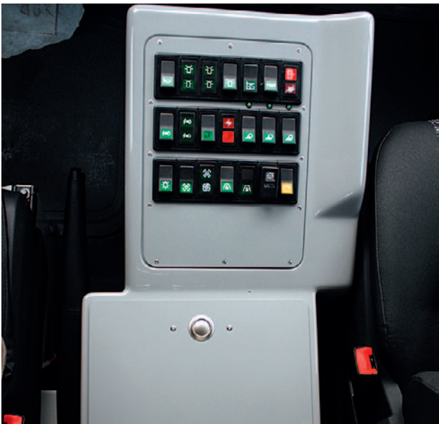
Die zentrale Mittelkonsole mit Ordnerfach im Fahrerhaus erleichtert die Bedienung der Warn- und Signalanlage.
