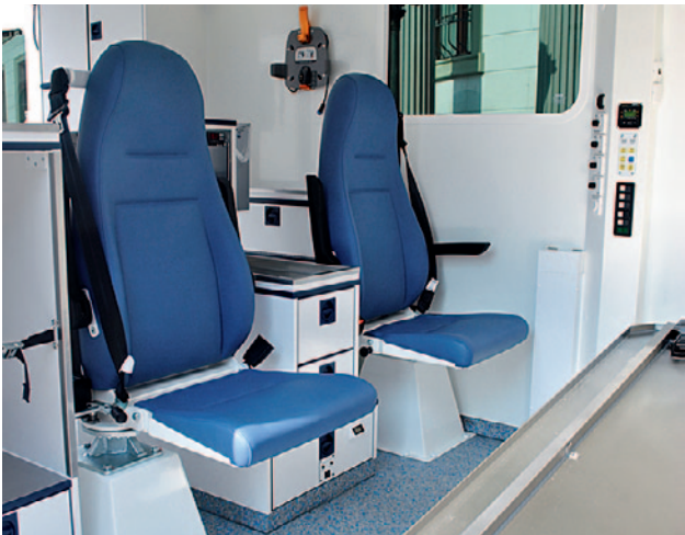
Dank der zwei Begleitersitze mit integriertem Dreipunktgurt sitzen die Begleiter sicher und der Säugling kann optimal versorgt werden.
