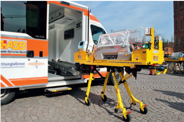
Der Inkubator wird einfach und direkt durch die seitliche Schiebetür geladen.
