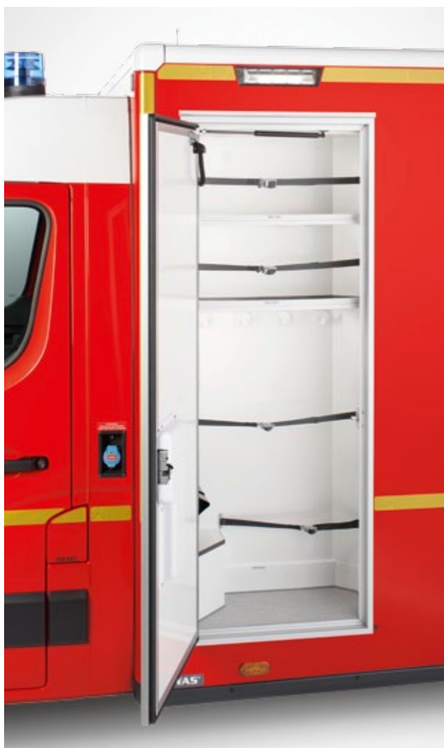
Un grand coffre extérieur pour le stockage du matériel non sanitaire.
