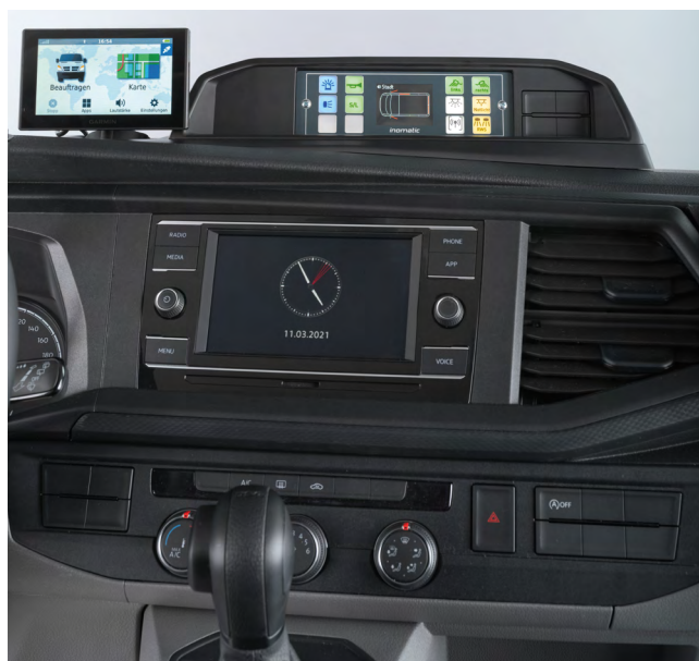
Centralny panel sterujący do instalacji ostrzegawczej zamocowany jest w konsoli na desce rozdzielczej.
