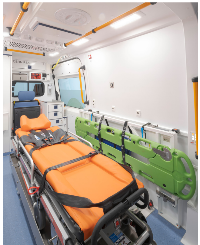
Le deuxième support de brancard fixé sur le panneau latéral est équipé d'un dispositif pour la civière et des accessoires.
