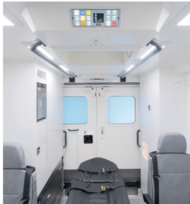
Le centre de plafond sert à accueillir la technique médicale, l'énergie et l'alimentation en oxygène ainsi que le panneau de commande pour piloter la table et d'autres fonctions essentielles.
