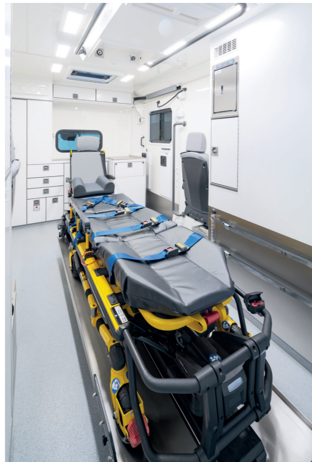
Trois sièges d'infirmières dans la cellule - tous avec ceinture à trois points intégrée, détection de la position du siège et, au choix, chauffage du siège - permettent un soin idéal au patient.
