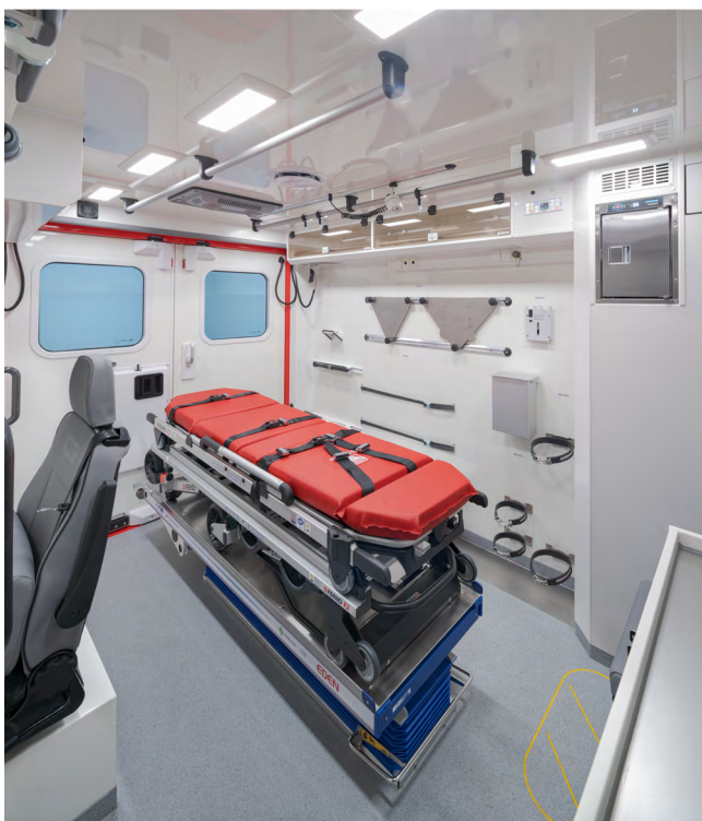
Wysokość wewnętrzna wynosząca 1,97 m w przejściach zapewnia optymalny komfort pracy.
