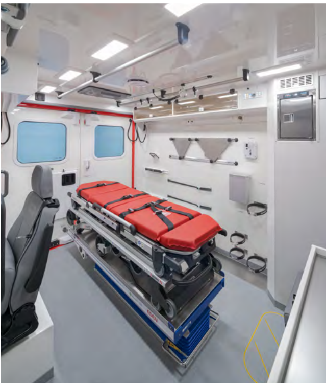
Une hauteur intérieure de 1,97 m dans les zones de passage, un volume généreux optimisé pour le confort de travail.
