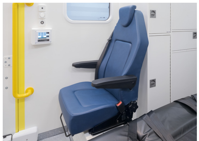
Siège confortable avec ceinture trois points intégrée, deux accoudoirs, dossier réglable et appuie-tête.
