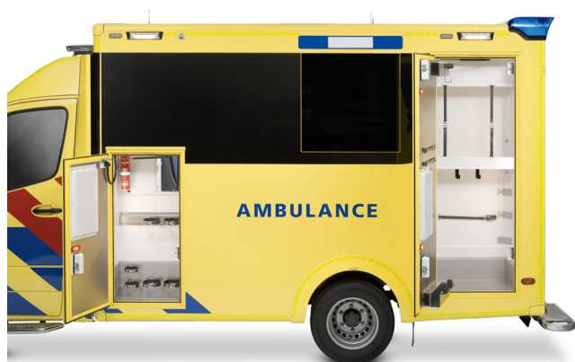
Les compartiments latéraux profonds sur le côté gauche, de véhicule offrent un grand espace de rangement pour le matériel médical, le matériel d'immobilisation et la chaise de transport.
