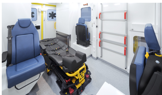
Cellule multifonctionnelle avec trois sièges d'infirmière positionnés à droite, à gauche et à la tête du patient.
