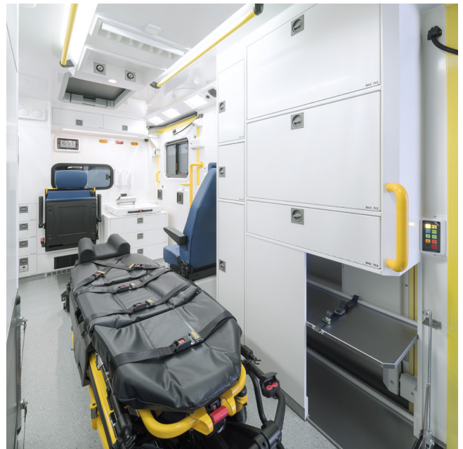
Armoire multifonctionnelle avec différents espaces de rangement, réalisée avec des volets ou des portes. Accessible de l'intérieur et de l'extérieur.
