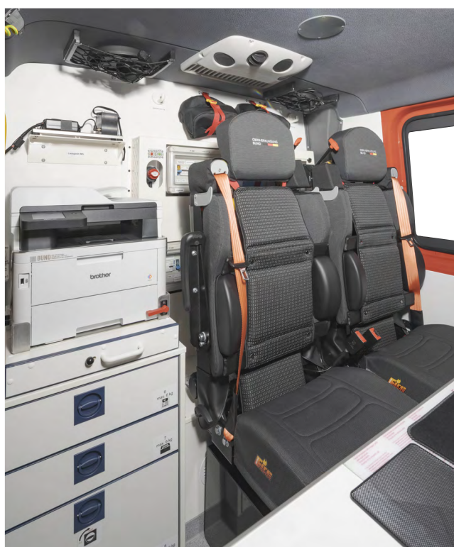
L'espace conducteur et l'espace de travail sont équipés de sièges spéciaux pouvant accueillir des appareils respiratoires à air comprimé.
