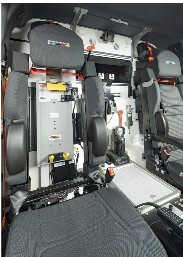
L'espace conducteur et l'espace de travail sont équipés de sièges spéciaux pouvant accueillir des appareils respiratoires à air comprimé.
