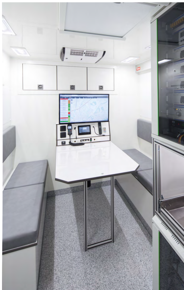
Une salle de réunion spacieuse pour le commandement des opérations : les informations provenant de la salle de communication sont transmises sur l'écran plat 32".
